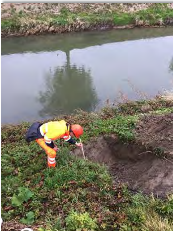
Au, km 2.5 - 2.6 links: Entnahme von Bodenproben und Baggerschlütze im Bereich der Stützmauer
