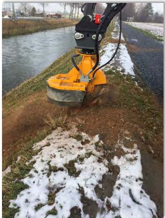
Widnau km 7.35 rechts, Wurzelstockfräse des Rheinunternehmens im Einsatz
