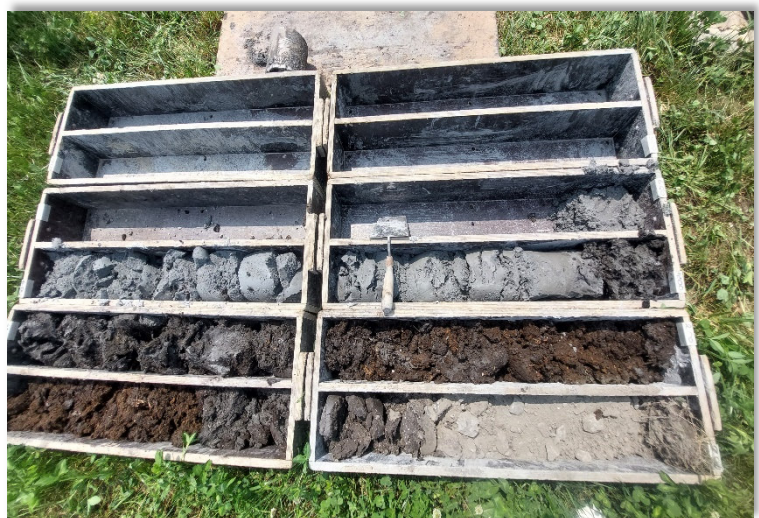
Bohrkernentnahme zur Bodenuntersuchung
