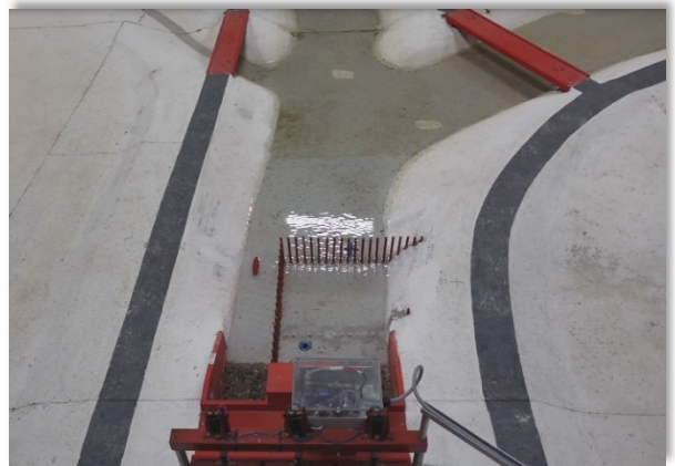
Schlauchboot passiert das Drosselbauwerk
