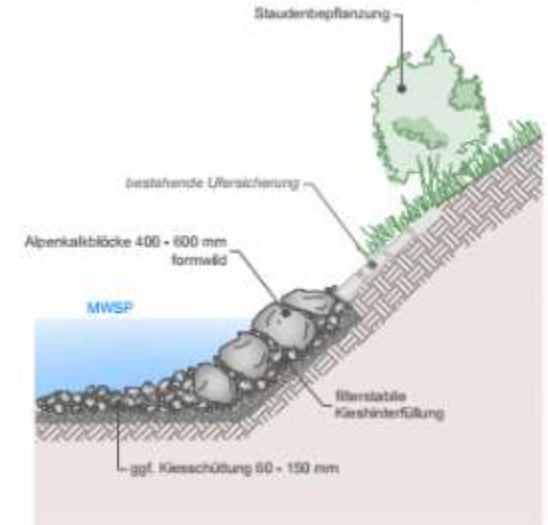
Detail A: Blocksatz Böschungsfuss
